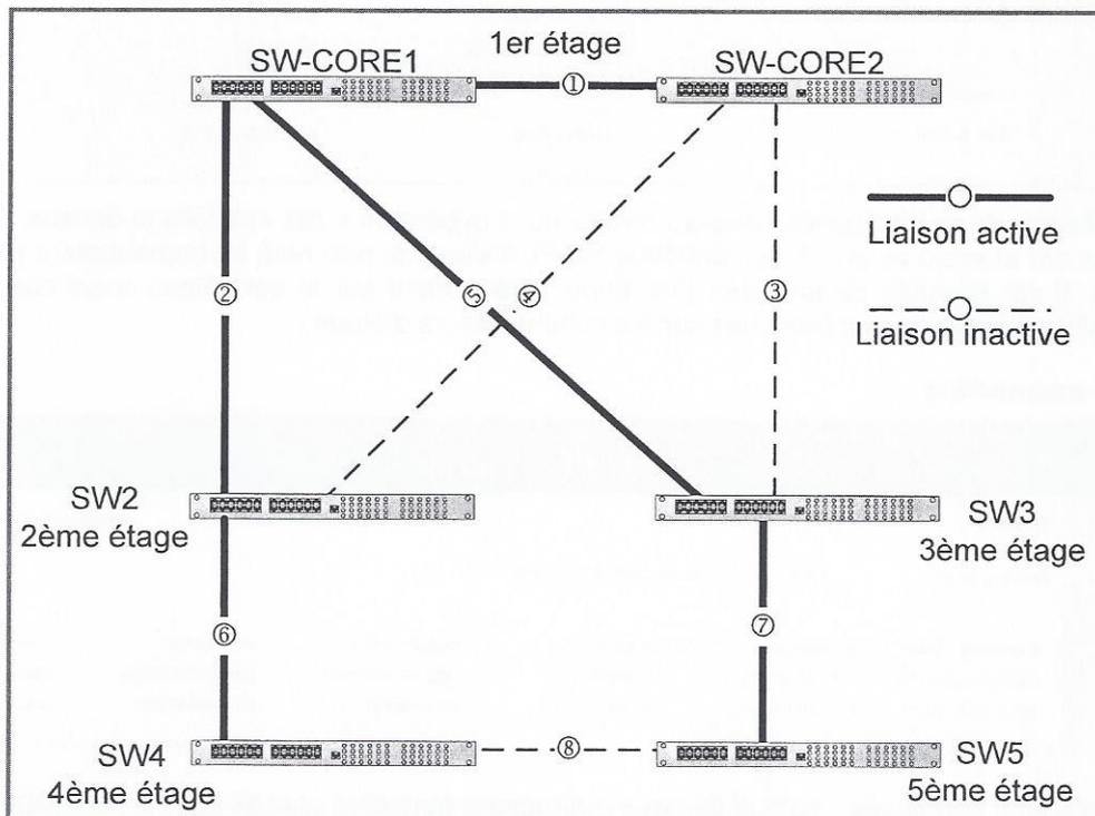
La liaison n°1 est en 10 GbE (10 Gigabit Ethernet). Les liaisons n°2 à n°8 sont toutes en fibre optique 1000 Base LX.
