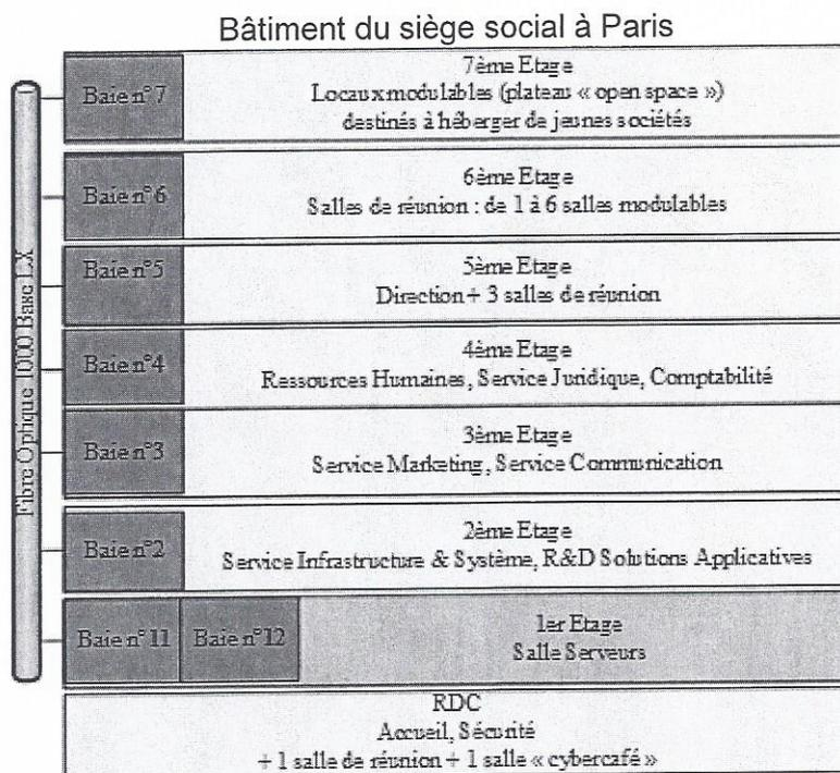
La salle « Serveurs » occupe une partie du 1<sup>er</sup> étage du bâtiment et les accès y sont restreints : étage accessible par ascenseur à l'aide d'une clé sécurisée, portes d'accès par escalier munies d'un lecteur de badge, sas d'entrée avec gardiennage 24h/24.
