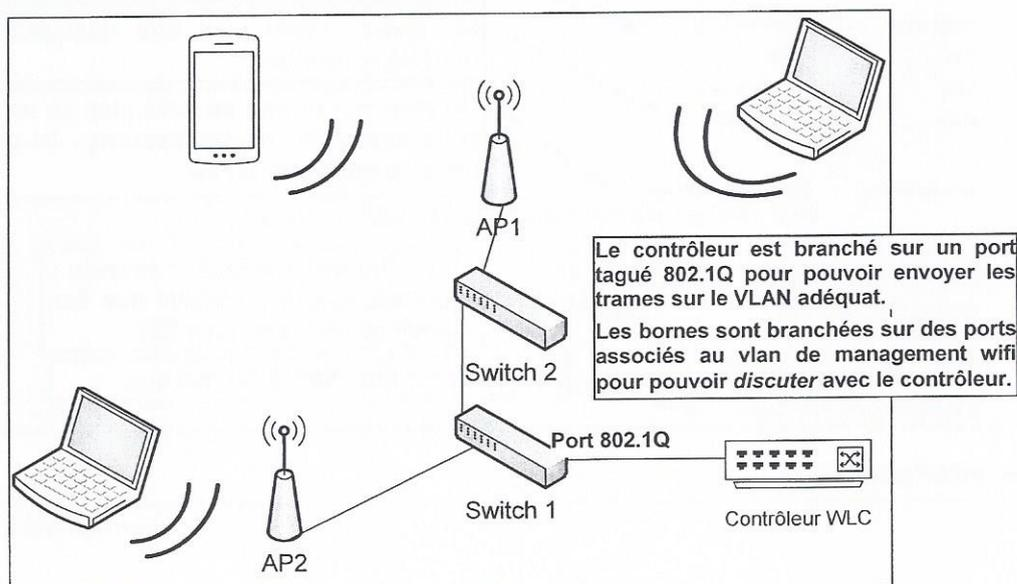
Ce boîtier WLC contrôle à distance toutes les bornes d'accès et c'est sur ce boîtier que l'administrateur va se connecter. Toute la configuration s'y trouve et c'est le WLC qui va commuter/router les trames vers les bonnes destinations et non plus les bornes elles-mêmes !
